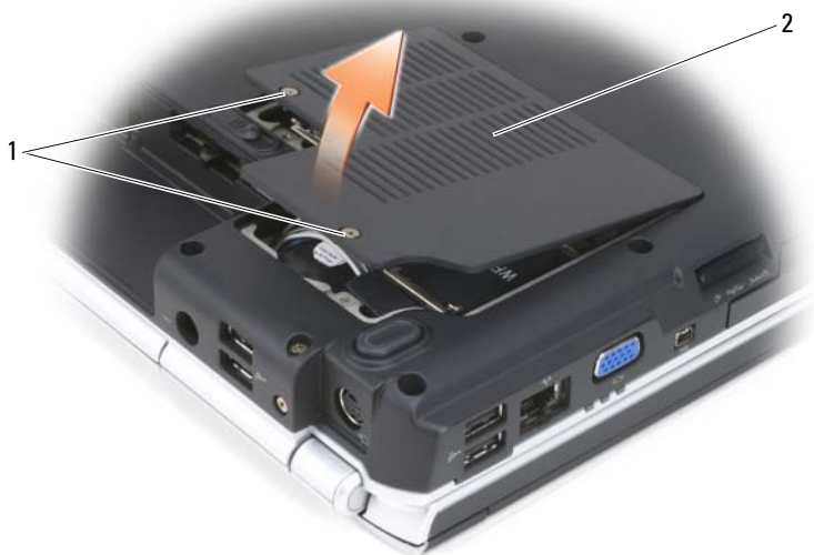
1 Unverlierbare Schrauben (2) 2 Gehäuse
