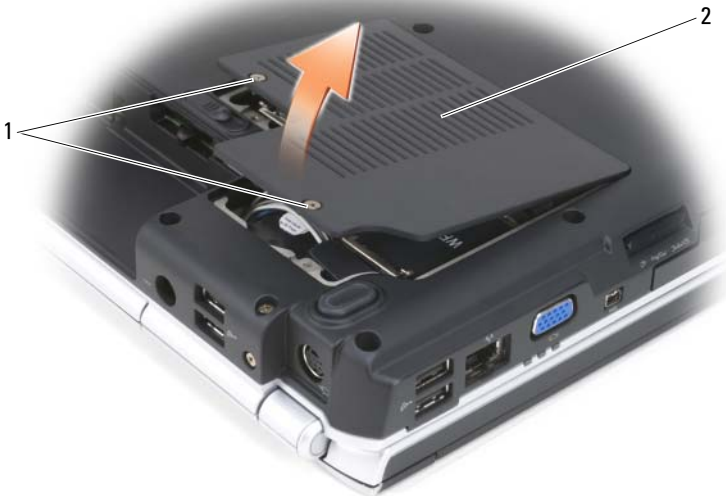
1 Unverlierbare Schrauben (2) 2 Gehäuse
